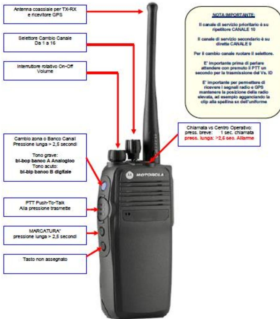
\* MARCATURA: ogni volta che si vuole trasmettere la propria posizione (Way Point) per indicare che si è in un punto di controllo o di importanza tale da doverlo segnalare premere a lungo >2,5 secondi il pulsante.
