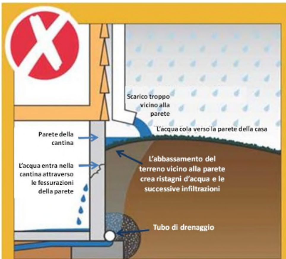
Casa con drenaggio scadente
