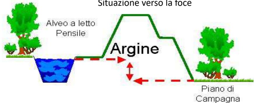
In mancanza di spazio, invece di arginature in terra, si può ricorrere a barriere in cemento armato o altri materiali.
