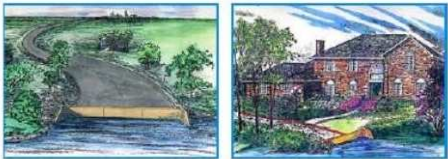
Queste barriere a scomparsa possono essere utilizzate per proteggere strade o passaggi (ad esempio le aperture nei sopralti arginali fissi).
