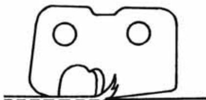
Limitatore di profondità troppo alto: il filo penetra troppo poco, la capacità di taglio della catena non è sfruttata in pieno, le superfici di scorrimento fra catena e lama di guida si usurano velocemente.
