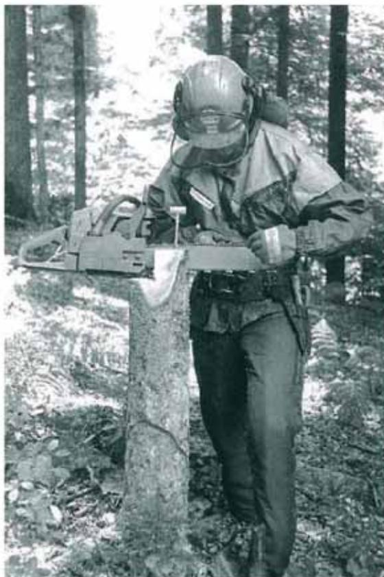
1. Controllare la tensione della catena;
